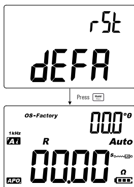
Figure 3-16 Réinitialisation des éléments de configuration
