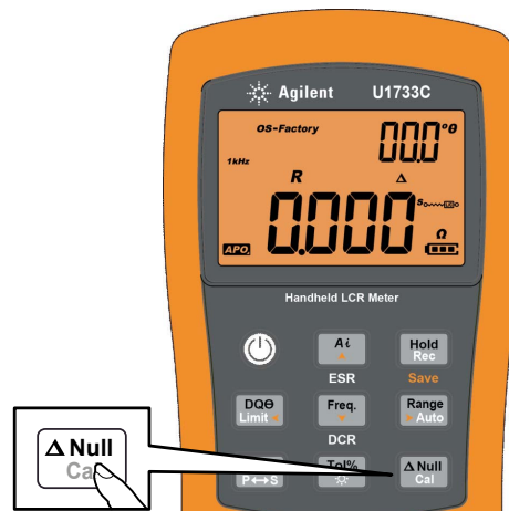
Figure 2-18 Utilisation de la fonction Null
