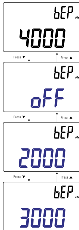
Figure 3-13 Modification de la fréquence du signal sonore
